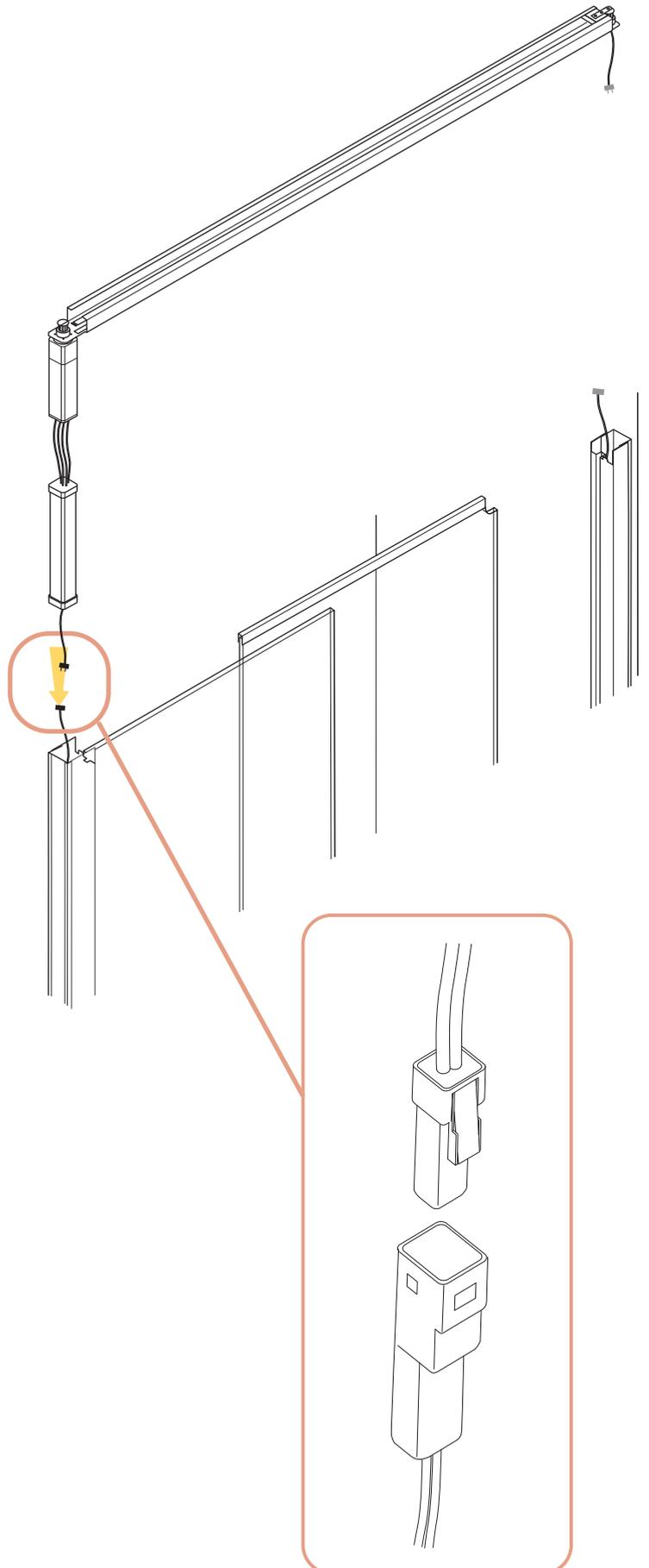
**9** Dopo aver inserito la scatola che contiene la scheda elettronica, infilare anche il motore, fissato al traverso, nel montante. Collegare i connettori del pulsante e infilare i cavi nel montante di battuta.
