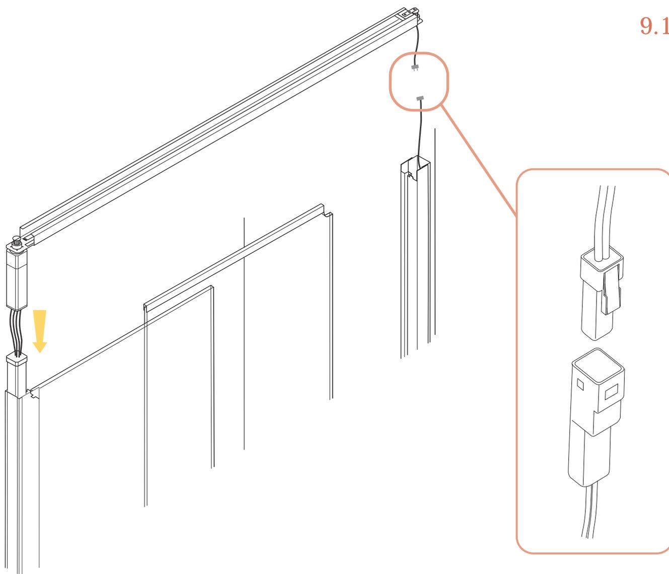
**10** Posizionare il traverso facendo in modo che la porta si infili nella fessura lunga e che il cristallo fisso si infili in quella corta. Inoltre, le flangie in acciaio presenti sui montanti verticali devono infilarsi nelle apposite fessure presenti sul traverso.
