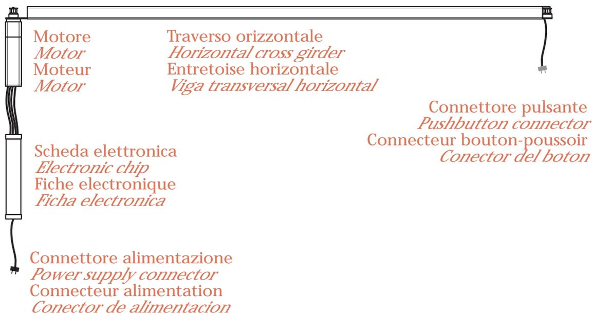
**8** Infilare la scatola che contiene la scheda elettronica nel montante della cabina (per facilitare questa operazione si consiglia di tenere leggermente aperti i 2 montanti), dopo aver collegato i connettori dell'alimentazione e aver spinto verso il basso, all'interno del montante, il cavo di alimentazione.
