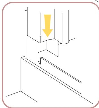
**6** Utilizzando le asole presenti sul montante D, accostare i montanti verticali al profilo di tenuta L. Verificare che le distanze X tra i montanti (6.1) siano uguali. In questo modo si preparerà lo spazio giusto per il cristallo apribile.
