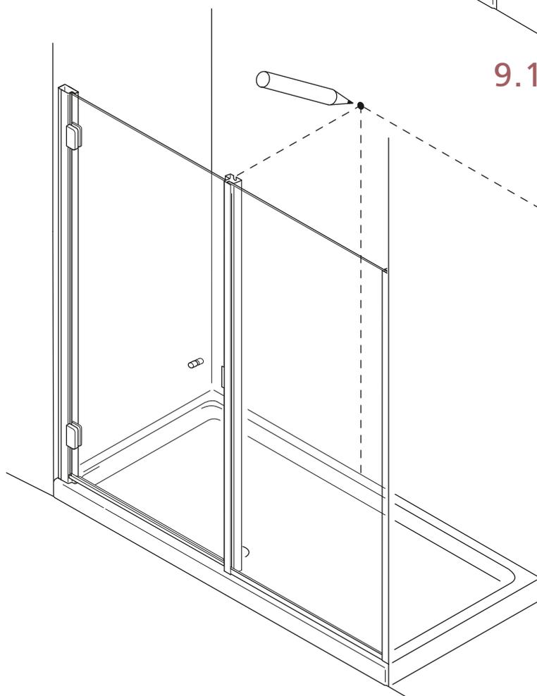
**10** Fissare la boccola a muro con il tassello e la vite fornite.
