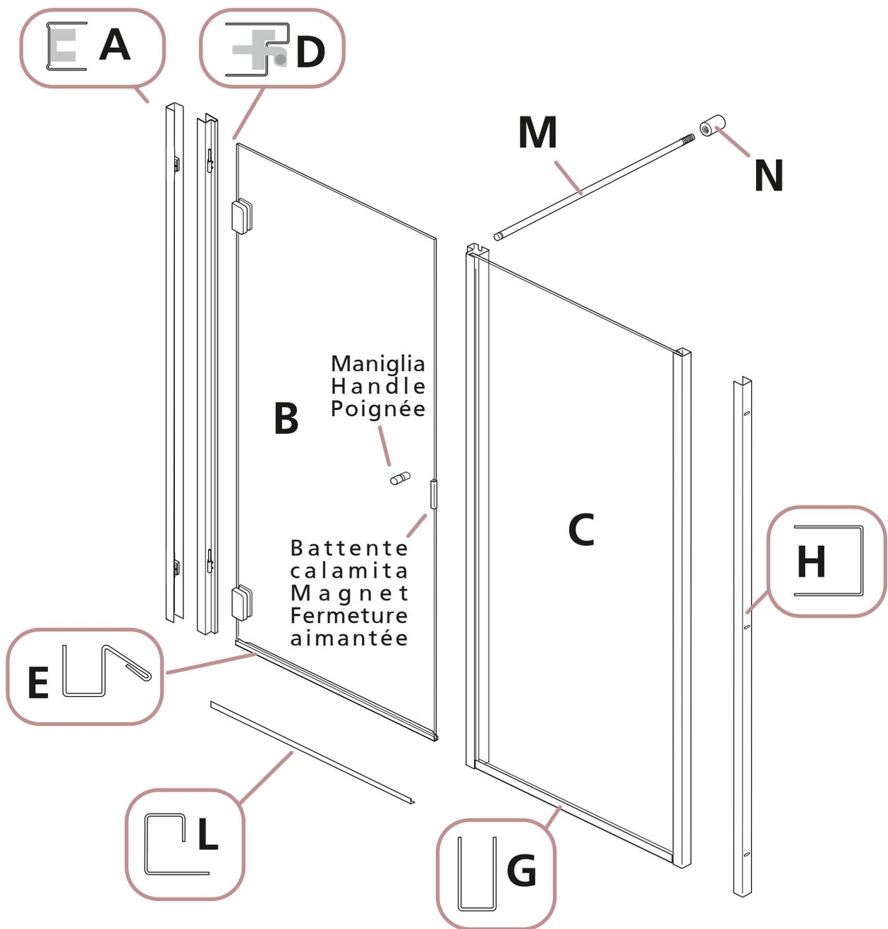
Attenzione: Prima di montare i vari componenti, togliere il PVC a protezione della superficie dell' acciaio inox
